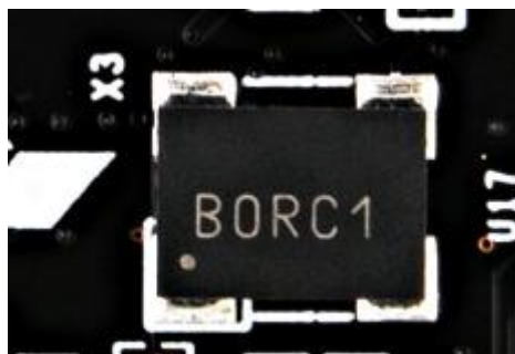
图 5-4 为有源晶振 50MHz 的实物图
