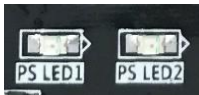
图 6-15 PS 的 LED 灯实物图
