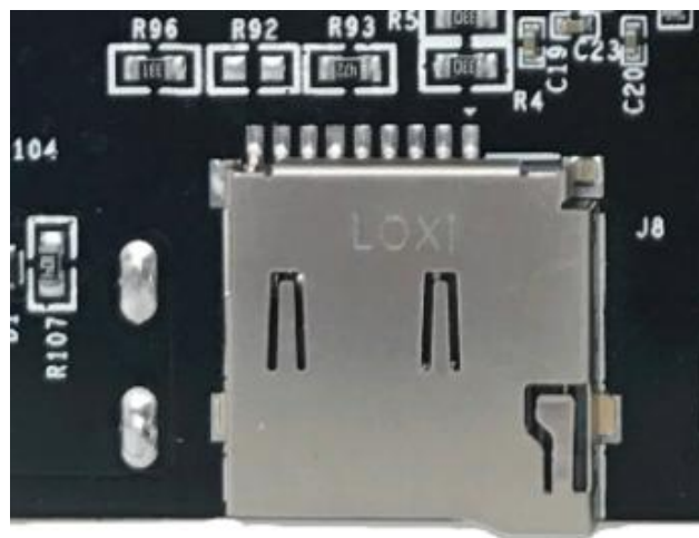
图 6-11 SD 卡槽实物图
