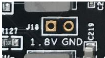
图 3-3 实物图中的电源测试点
