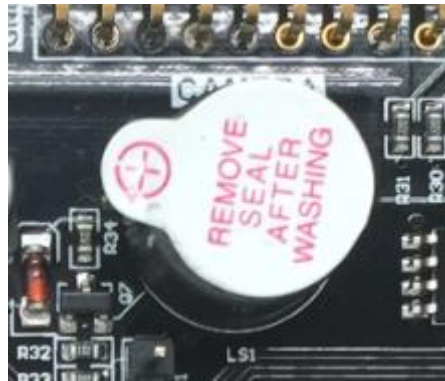
图 16.2 蜂鸣器原理图
