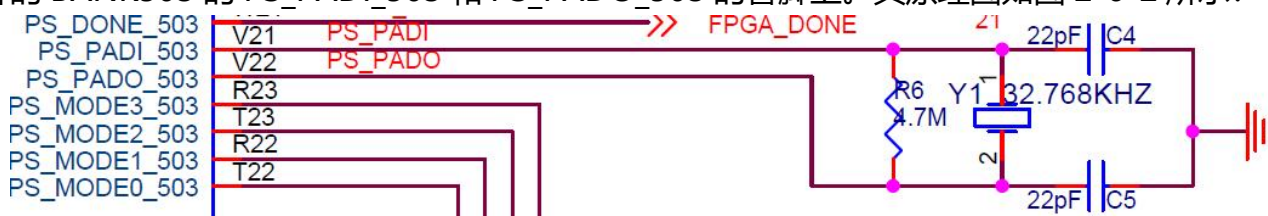
图 2-6-2 RTC 的无源晶振
